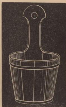
Fig. 169. Daubenfass aus Föhrenholz.
